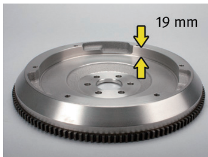
画像 1：OE No. 90536140 / 616169、 周囲に刻み目なし、フライホイールの深さ 19mm
